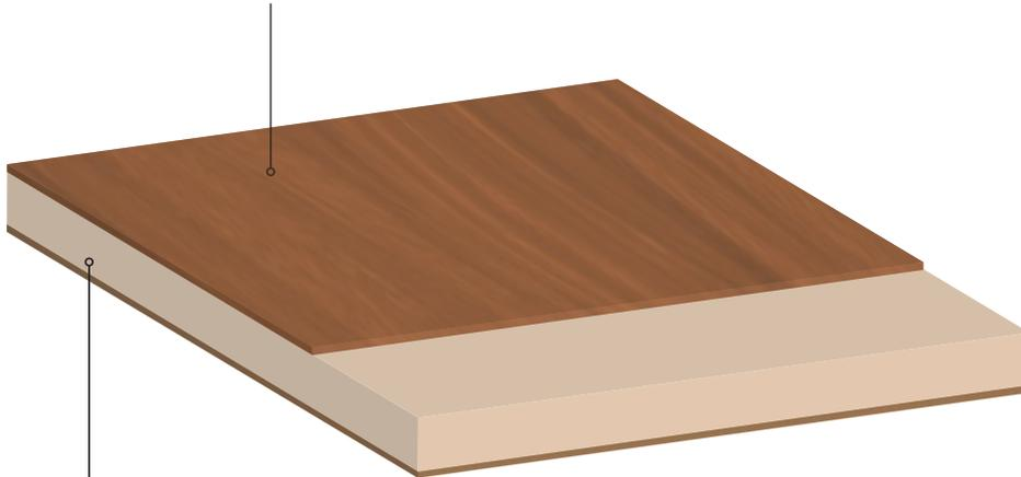
Alle möglichen Trägerplatten wie MDF, Span, Sperrhölzer, Tischler- und Leichtbauplatten u.a.m. veredelt RoHol zu wertvollen und einzigartigen edelfurnierten Materialien.
